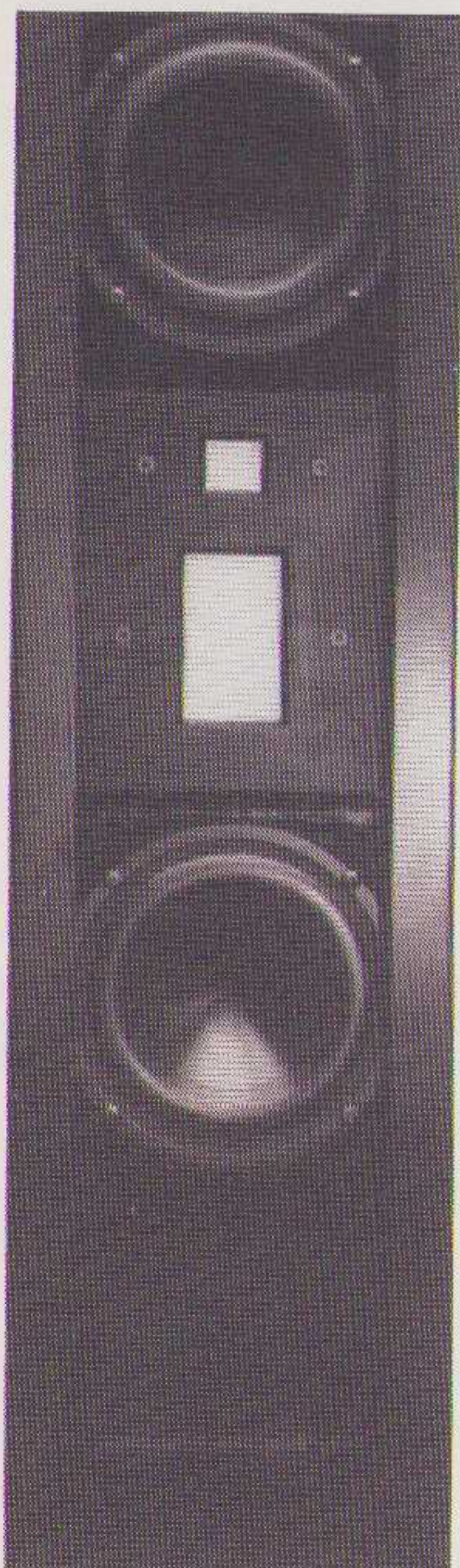
Het front van de Piega LDR 6.0 van nabij bekeken. Duide-lijk is de gecombineerde mid- den-hoog bandunit te zien. Deze unit wordt op specifica- tie bij Philips vervaardigd en wijkt dus (in gunstige zin) af van de gebruikelijke Philips band- units.
